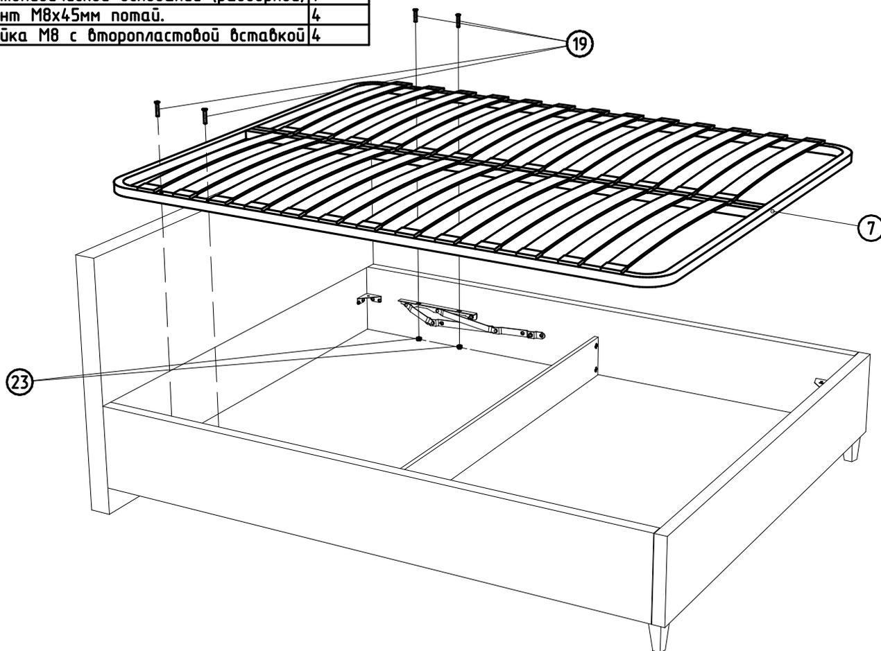
1. Распределить равномерно решетку между боковыми царгами, расстояние должно быть одинаковое со всех сторон (на схеме обозначено А)
